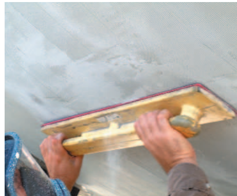
Applicazione dello stucco Nautilus Epoxy Light Filler con spatola dentata, carteggiatura con morale carta 40, seguita poi dalla seconda mano con spatola liscia
