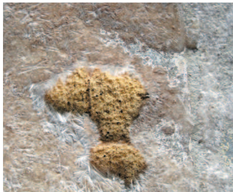
Stato della carena dopo la sabbatura e misurazione dell'umidità
