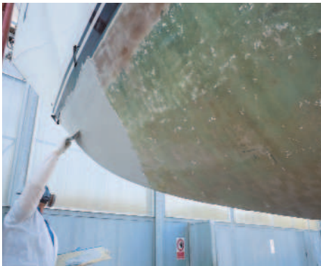
Applicazione dello stucco Nautilus Epoxy Light Filler con spatola dentata, carteggiatura con morale carta 40, seguita poi dalla seconda mano con spatola liscia
