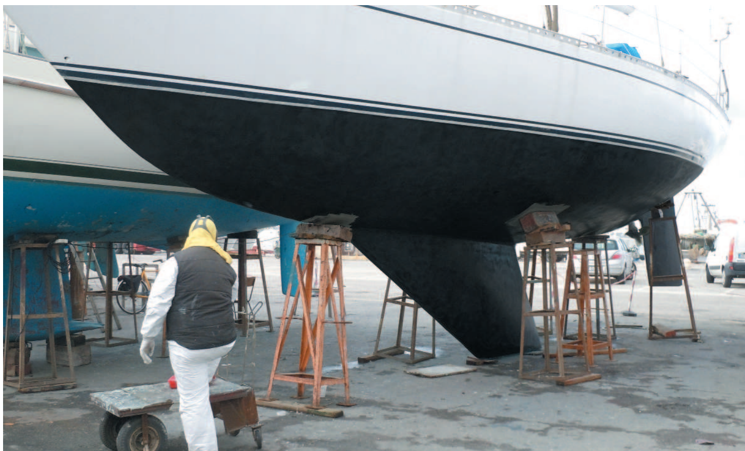
Fine dei lavori in banchina e applicazione antivegetativa Nautilus SP colore nero
