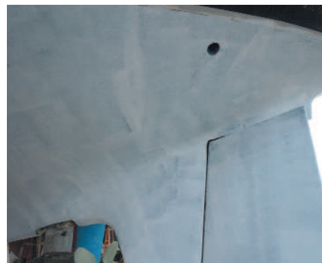
Applicazione mano di 10 10 CFS, altre mani con additivo A20 di colore nero (grafite) e mano di Epoxy Primer
