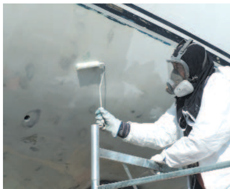
Applicazione mano di 10 10 CFS, altre mani con additivo A20 di colore nero (grafite) e mano di Epoxy Primer
