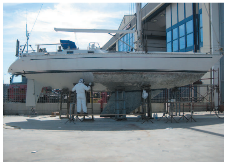
Veduta della barca durante la stuccatura
