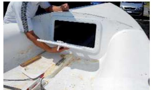
Qui è situato il caricabasso della scotta di randa e deve resistere a forti carichi di trazione durante la navigazione. Si interviene prima sigillando tutti i fori delle vecchie viti con **10 10 CFS** e **Microfibre Minerali**.
