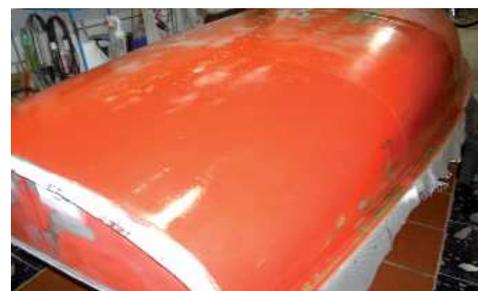
Applicazione della prima mano di **Nautilus Epoxy Primer** all'interno dello scafo.
