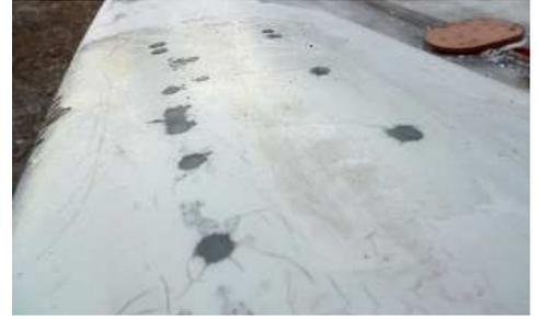
Si procede al taglio su misura per montare un nuovo portello per il vano di prua. **Nautilus Sealant** è la gomma poliuretanicca che viene applicata lungo il bordo interno e poi avvitato.
