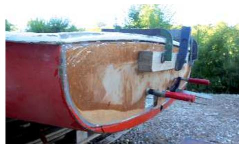
Girata la barca a pancia in su, si carteggia bene e si pulisce. Si applica una mano di **10 10 CFS**, si stende un tessuto in fibra di vetro biassiale da 300 g, e si dà la seconda mano di resina ad impregnare bene il tessuto. Seguiranno 2 mani di **Nautilus Epoxy Primer** e smalto **Nautilus Enamel**.
