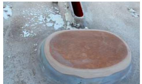
Sempre da questo punto parte la cassa della deriva. Si costruiranno con del compensato delle parti ad hoc. Per gli incollaggi si utilizzerà sempre la **resina epossidica 10 10 CFS** e **Addensante n°2**.
